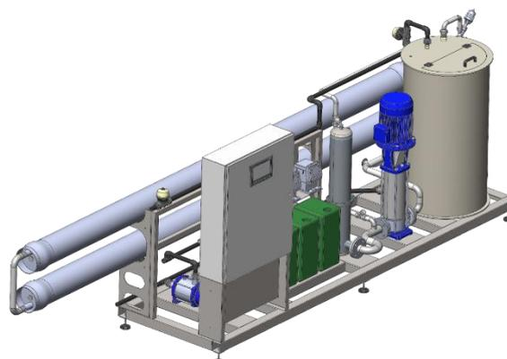
Schema Umkehrosmose mit Antiscalant-Dosierung
