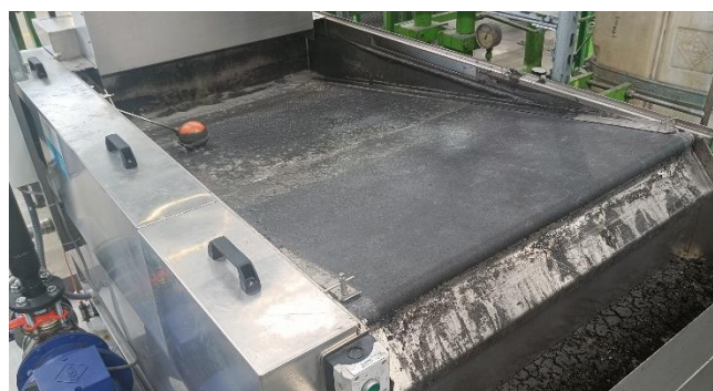
Detail Filtervlies mit Schwimmerschalter im Betrieb
